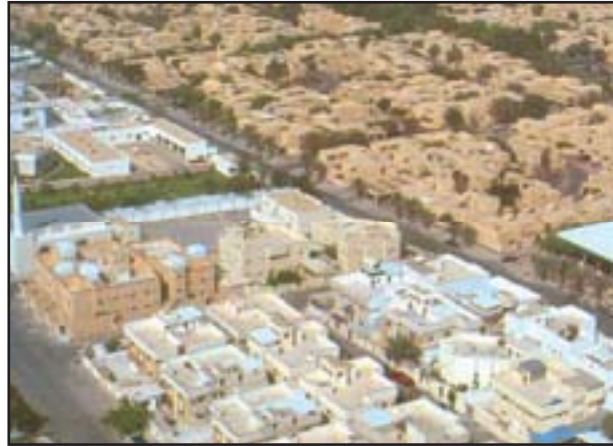
الشكل رقم (٢-٢) التخطيط متباعد الكتل في أحياء الرياض الجديدة. كتل صماء منفصلة وفراغات خارجية كبيرة.
