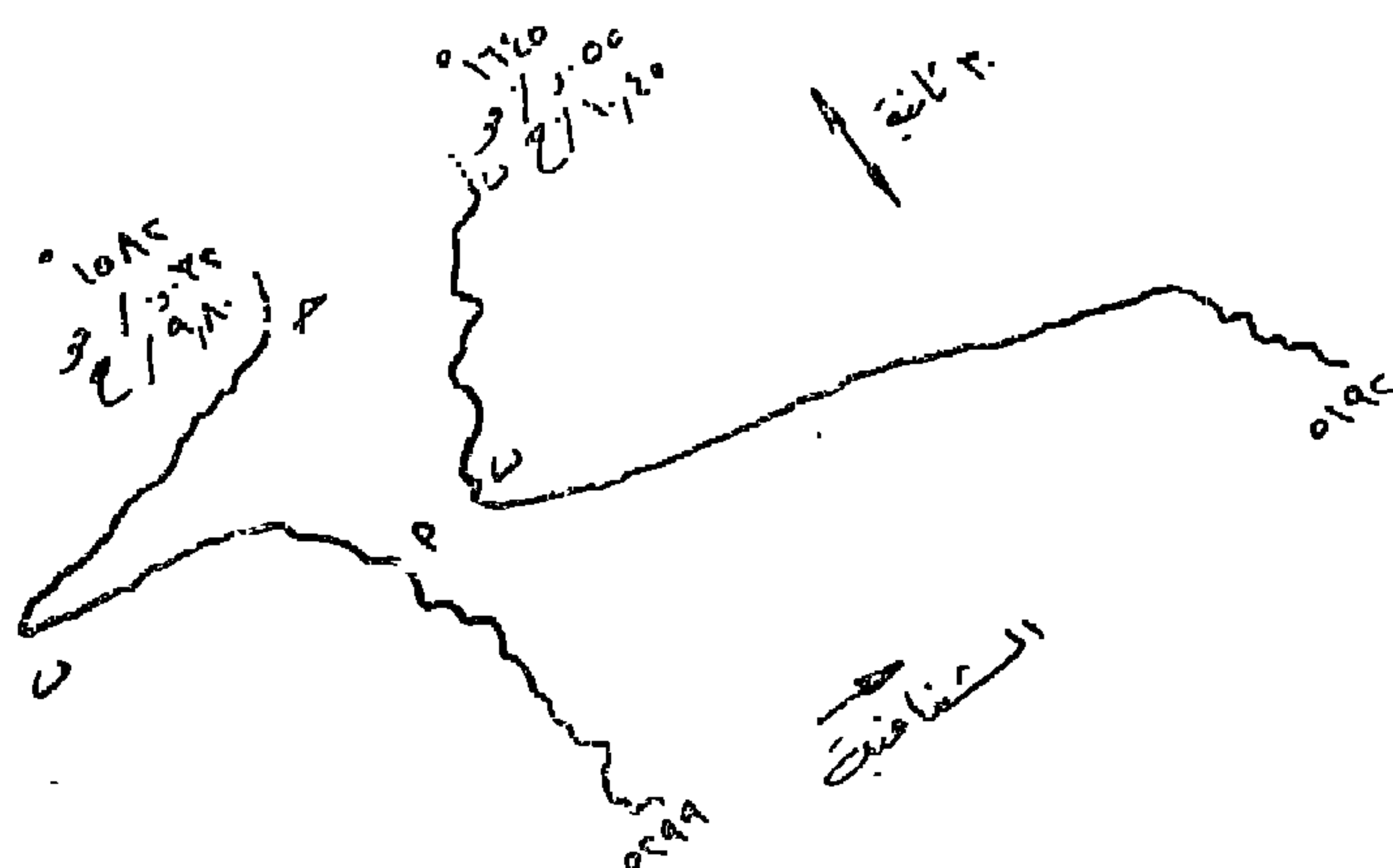
شكل (٥٩) : الخط البياني الذى يوضع تغير شفافية شعلة اللهب عند فوهة المحول
